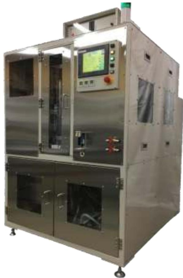
在超音波振动板和超音波稳定保护反射板之间仅夹入金属掩模所需要的清洗部位，并向其导入脱气后的清洗液。整个时间周期，大约仅需要10秒钟。
