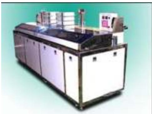
将从印刷机上取下的凹版滚筒放在小车上，移动它，并将其与该单周期全自动凹版滚筒清洗设备组合，然后按下按钮开关。凹版滚筒自动夹紧，输送到清洗槽种，并在进行强大的超音波清洗的同时旋转。
