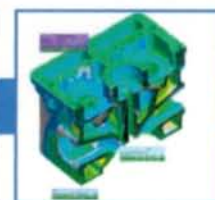
アルミシリンダーヘッド の3D計測とCADの交渉値 ・実績値の比較
