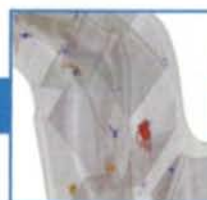
アルミ鋳造品のpore volume自動解析
