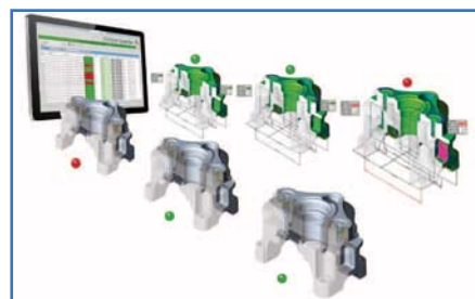
3D speed|ADRを用いた産業用の自動量産品検査および寸法計測テスト
