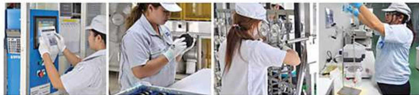
バーコードを読み取ってラインに投入 工場内は検査しやすい明るさに設定 処理前に製品の取り付けを行う 定期的に硫酸などの濃度を測定する
