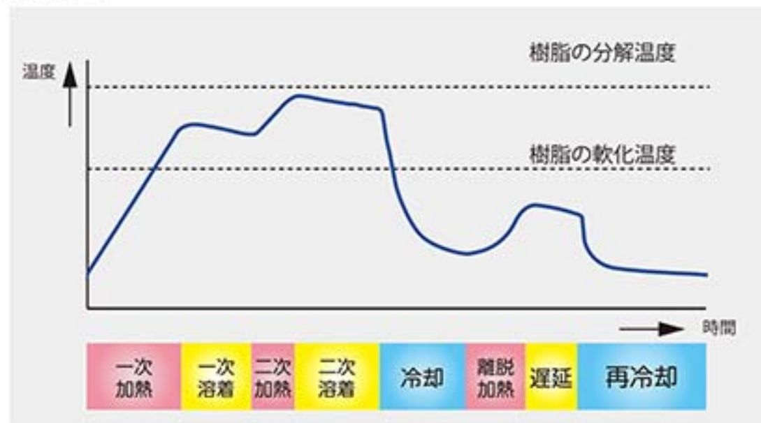
<タイマー制御溶着チップ温度推移イメージ図>
